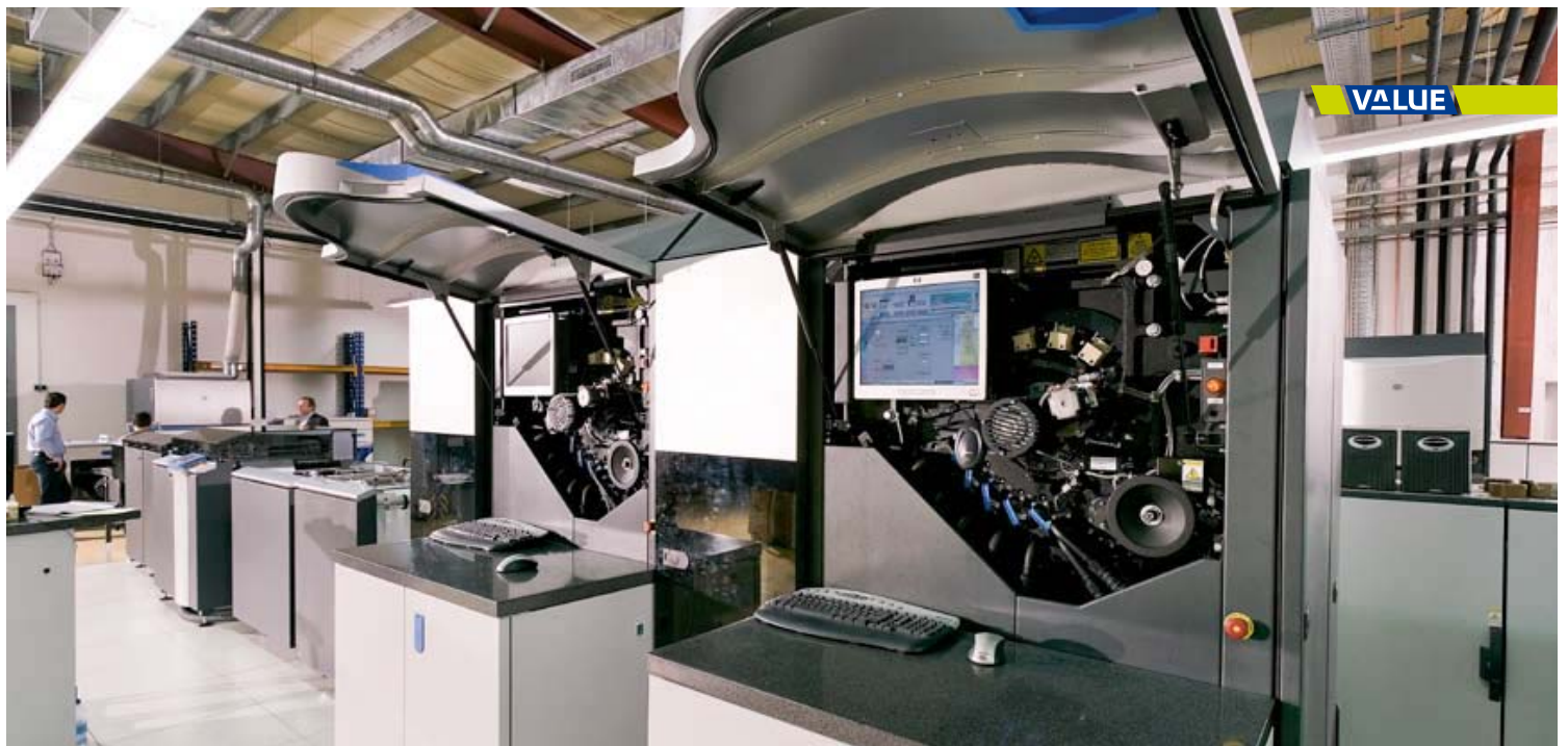
Das Innenleben einer HP Indigo w3250 Zehnfarben-Rollendigitaldruckmaschine.
